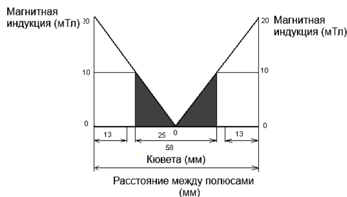
Рисунок 2 – Распределение магнитной индукции между полюсами электромагнитов и на полюсах электромагнитов (затемненная часть соответствует кювете с ферромагнитным порошком)
