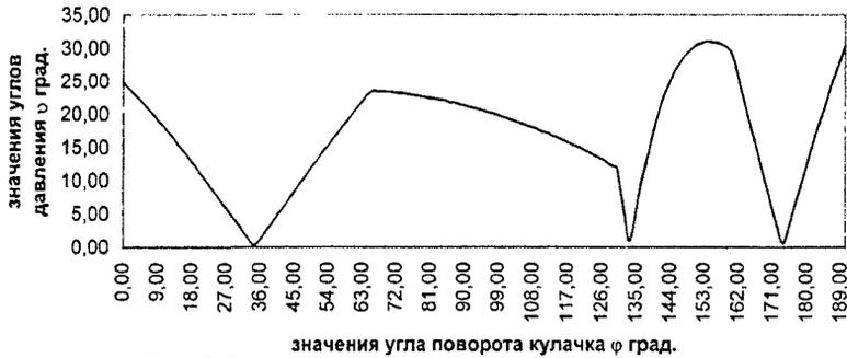
Рис. 5. Зависимость углов давления от угла поворота кулачка
