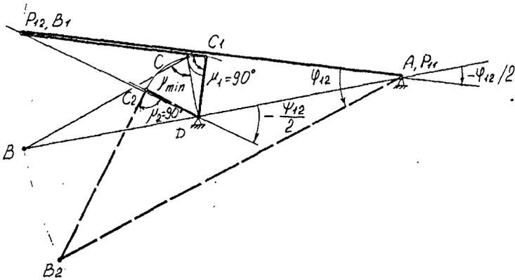
Рис. 6. Синтез четырехзвенника по трем положениям при наличии ограничений на углы передачи.
